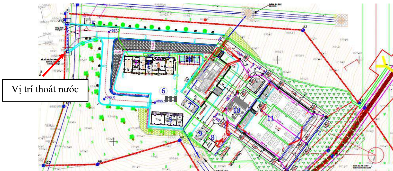
Hình 4. 5: Mặt bằng thoát nước dự án
