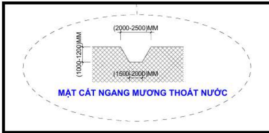
Hình 7. Mặt cắt ngang mương thoát nước mưa khu vực chế biến tại cơ sở
