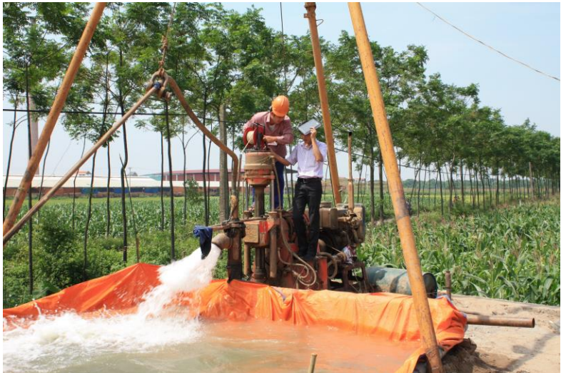
Cán bộ Cục QLNN đi kiểm tra khoan, bơm nước thí nghiệm tại Hưng Yên
