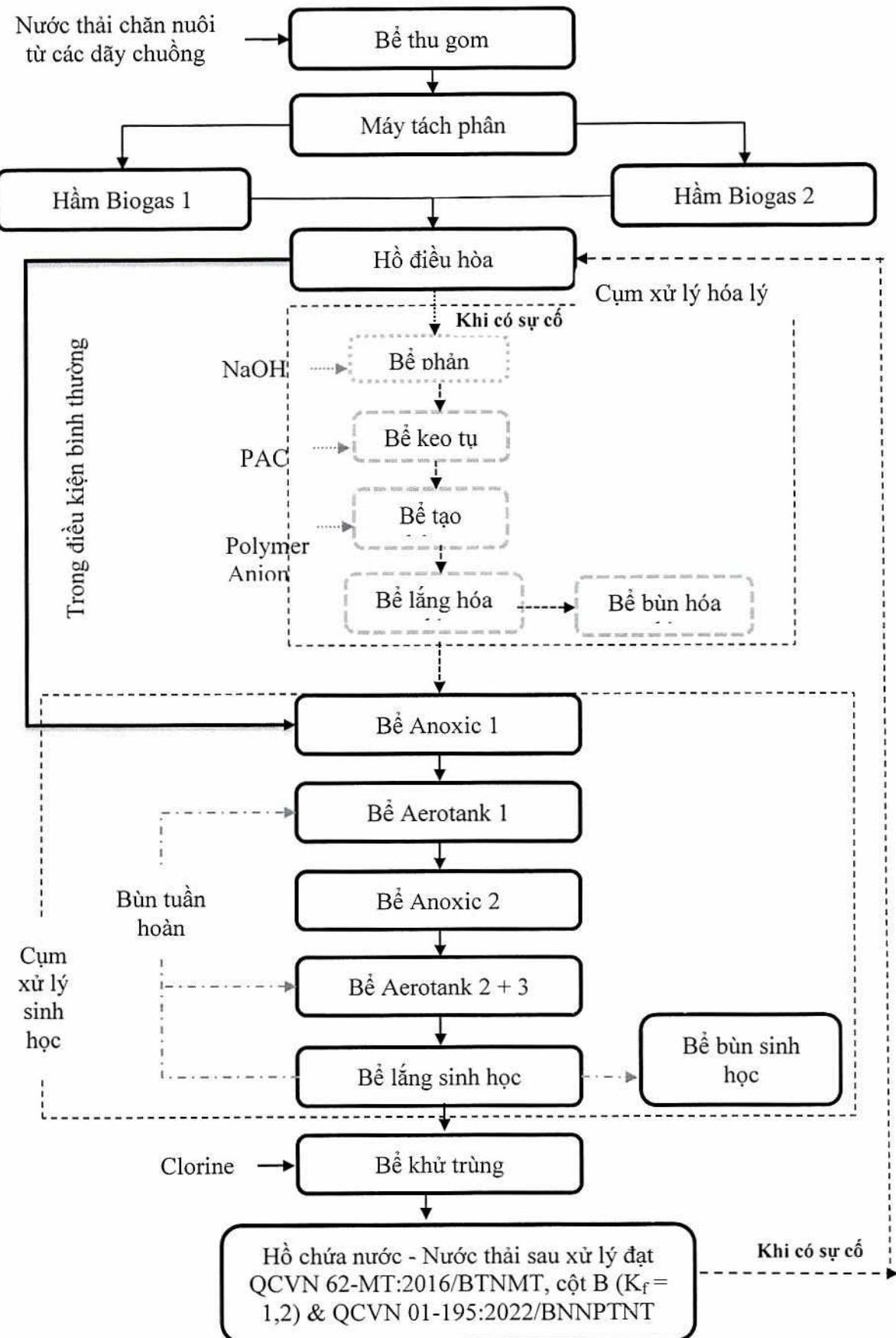
*Ghi chú: Trong điều kiện hoạt động bình thường thì nước thải sau hồ điều hòa sẽ được bơm lên cụm xử lý sinh học để xử lý nước thải. Nếu cụm xử lý sinh học xảy ra sự cố hoặc xử lý nước thải chưa đảm bảo quy chuẩn thì nước thải sau bể khử trùng sẽ được bơm lên cụm hóa lý để xử lý.*
