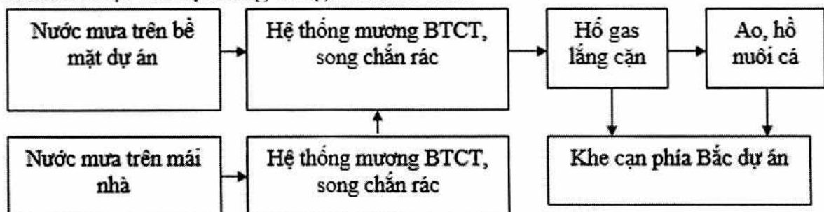
Sơ đồ hệ thống thu gom và xử lý nước mưa của trang trại
