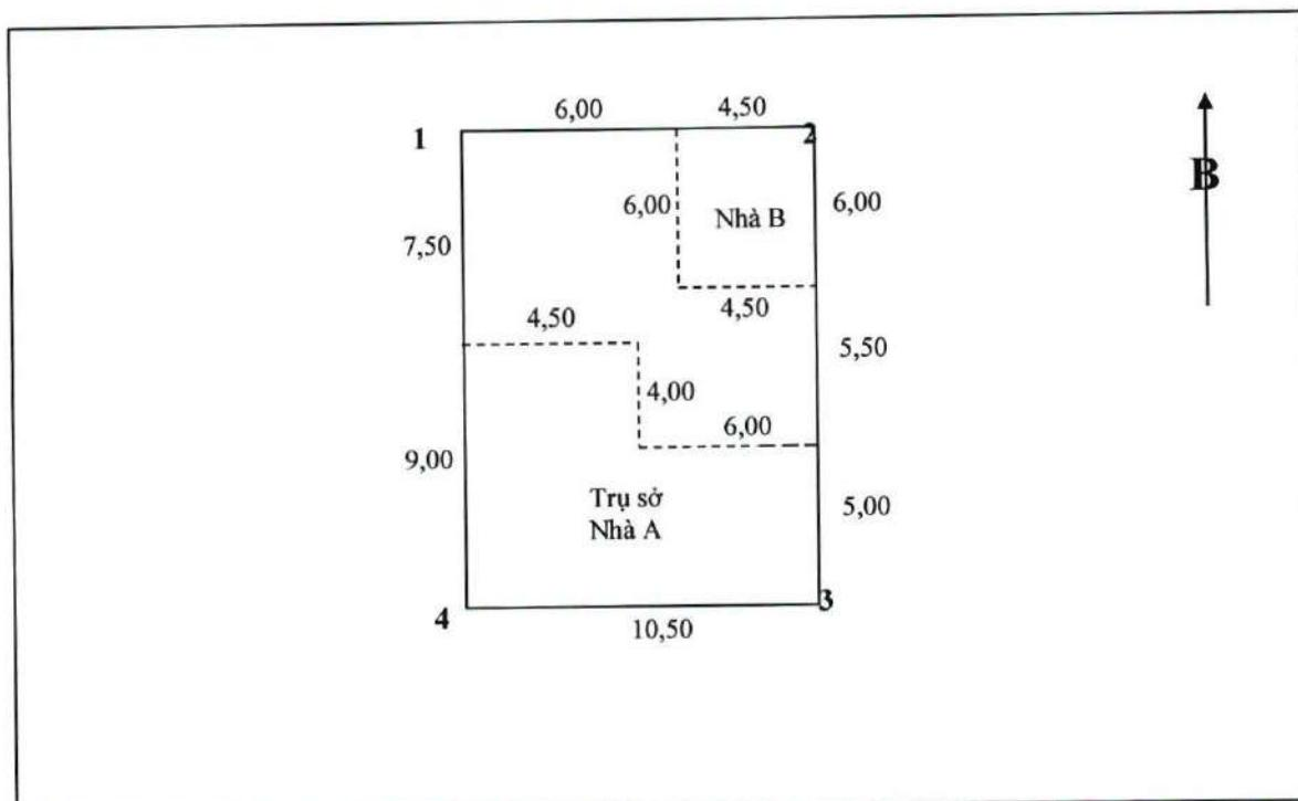
**Hình 8. Sơ đồ thửa đất có căn hộ chung cư**
