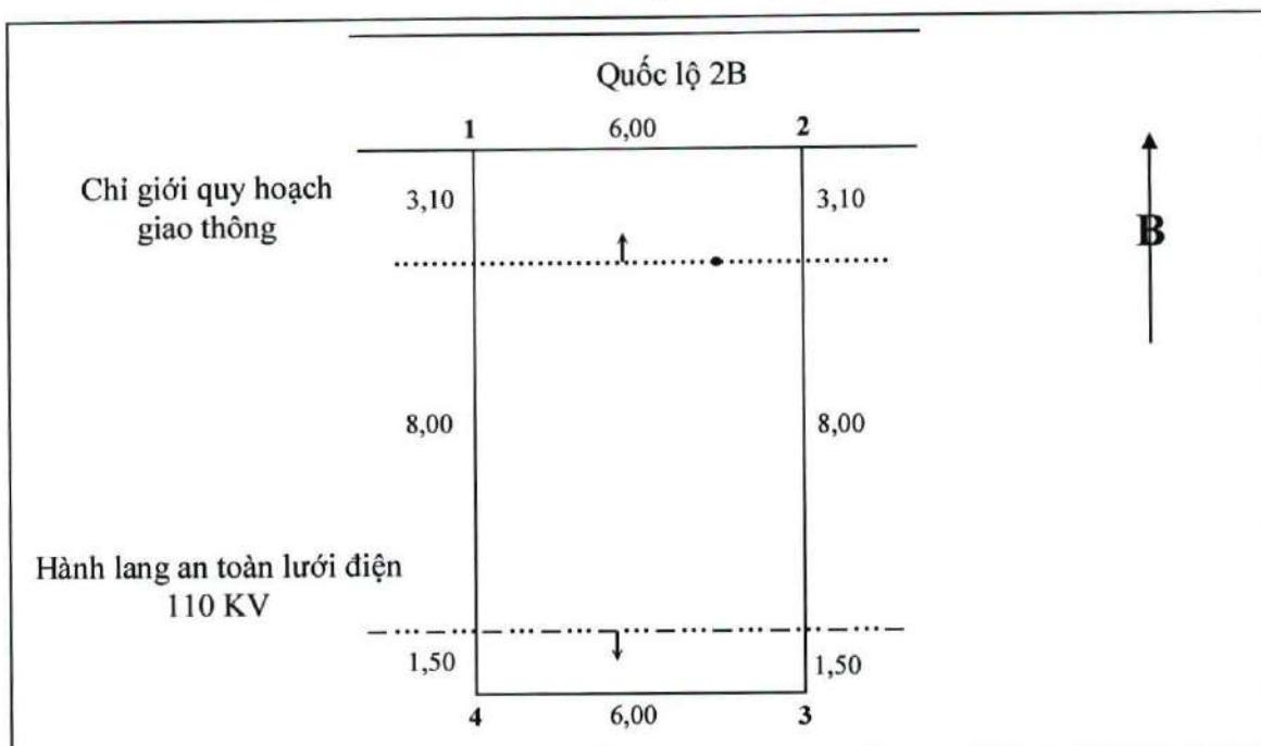
**Hình 2. Sơ đồ thửa đất có nhiều cạnh thửa**
