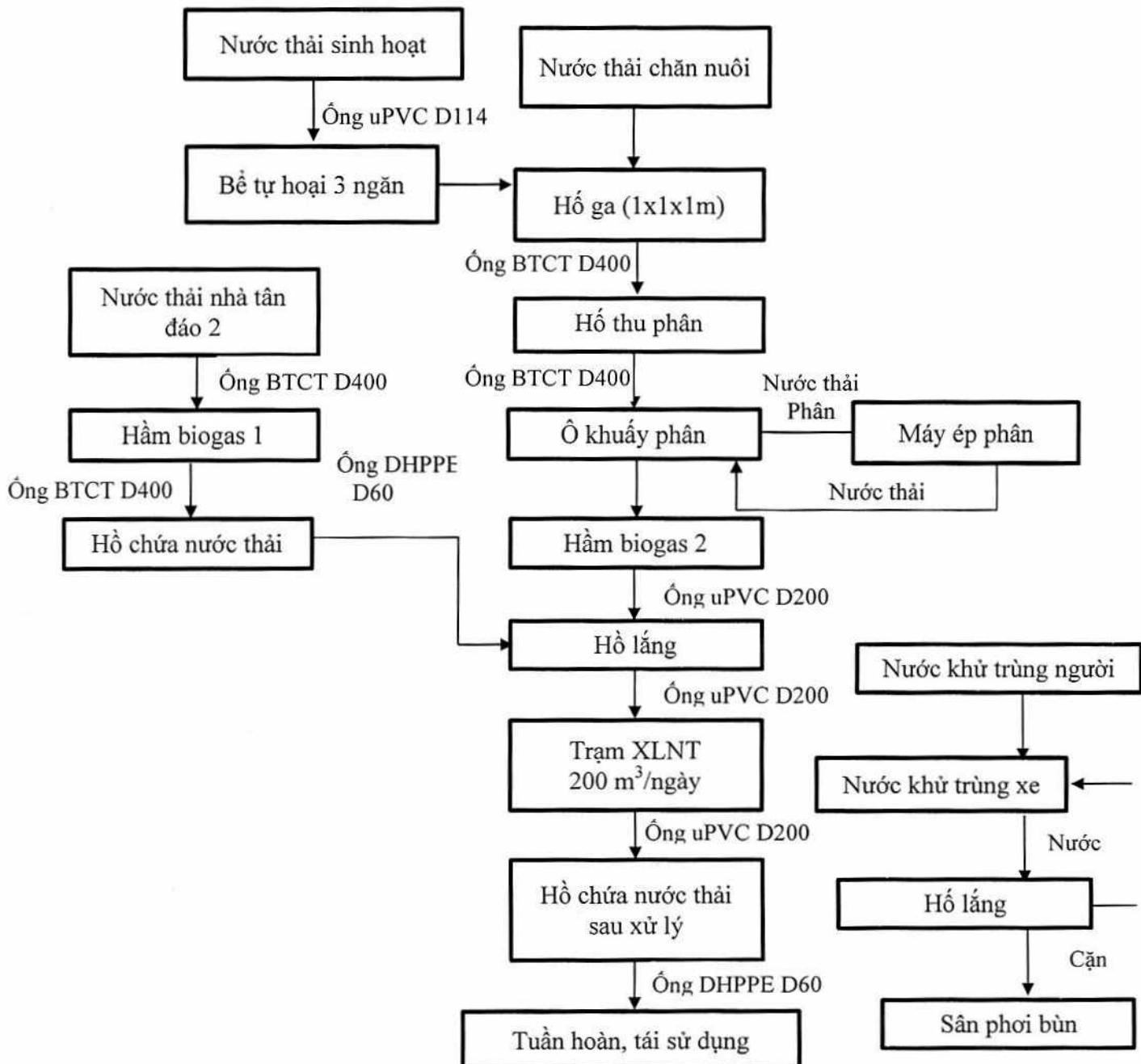
Dự án xây dựng hệ thống thu gom và xử lý nước thải tách biệt với hệ thống thu gom và thoát nước mưa.
